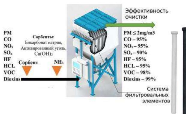
Рис. 1.1. Общий вид керамического фильтра с указанием очищаемых компонентов из газового потока [35].
