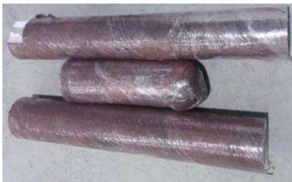
Рис. 4.9. Распиленный образец ФГВК после испытаний в СГОК.
